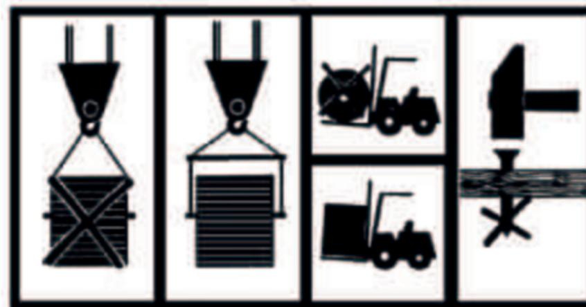
Максимальные размеры: диаметр шейки 4 м, ширина 2,4 м, масса барабана с кабелем 25 тонн. Минимальный диаметр шейки кабеля должен быть не менее 15\*D кабеля. При погрузке и выгрузке барабанов с кабелем необходимо использовать грузозахватное устройство (траверсу), использование которого позволит предохранить кабель при погрузке и выгрузке.
